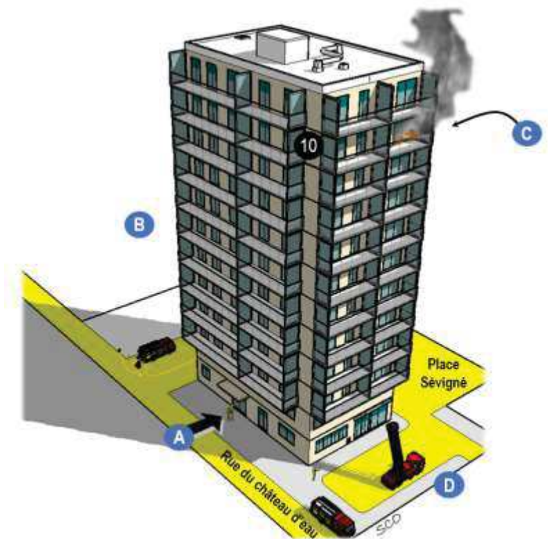
Schéma n°13 : Principe d'appellation des façades
