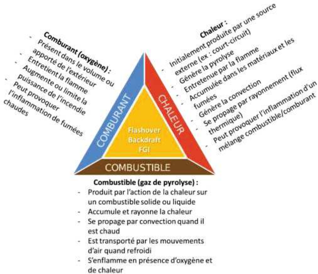
Schéma n°4 : synthèse des phénomènes thermiques associés à un développement rapide du feu
